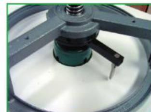
Adaptation à l'aide de la scie-trépan
