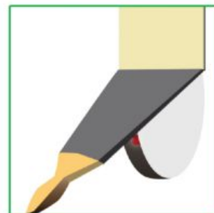
Enfoncer de 2 mm et boucher à l'enduit
